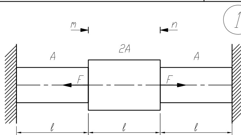
Построить эпюры  $N$ ,  $\sigma$ ,  $w$  для стержня, нагруженного силами  $F$ .
